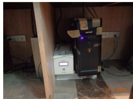
ภาพที่ 2.2-36 การเปลี่ยนแบตเตอรี่ เครื่องสำรองไฟฟ้าของคอมพิวเตอร์
